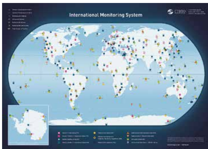
Figur 2: Det internationella nätverket för verifikation av CTBT (International Monitoring System — IMS). Systemet innehåller 321 mätstationer uppdelat på 170 seismologiska mätsystem, 11 hydroakustiska stationer, 60 för infraljud, och 80 för mätningar av atmosfärisk radioaktivitet, varav 40 också skall ha kapacitet att mäta radioaktivt xenon. Nätverket är idag utbyggt till cirka 90 % (bild: CTBTO, www.ctbto.org ).
