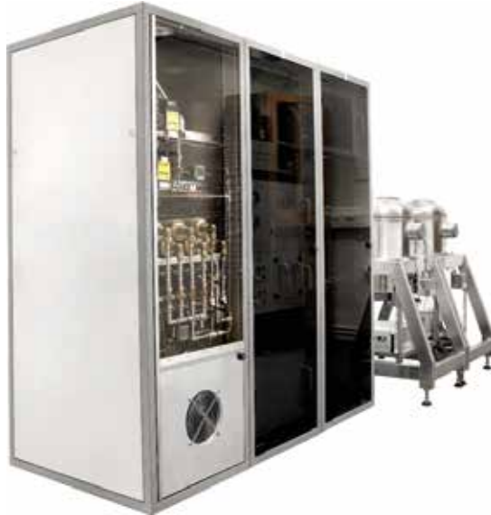
Figur 6: Senaste versionen av IMS-systemet för insamling och detektion av radioaktivt xenon, som utvecklats på FOI (SAUNA III). De tre skåpen innehåller (från vänster till höger) moduler för insamling och anrikning av xenon, provberedning och kvantifiering samt datatagning och systemövervakning. Längst till höger syns de två detektorer som används för att mäta aktiviteten från det insamlade och separerade xenonet (foto: Scienta Envinet).
