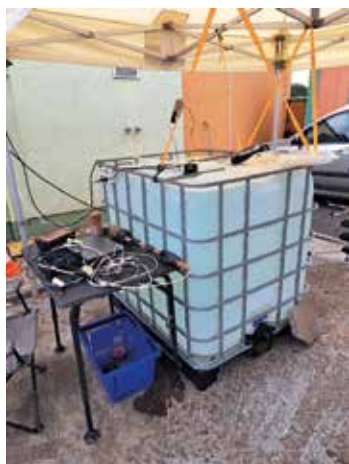
Figur 6: Testuppställning hos SURO, det tjeckiska nationella strålskydds-institutet, där ArtEmis sensorn placeras i en 1 m 3 stor tank för kalibrering av sensorn och bestämning av känsligheten.
