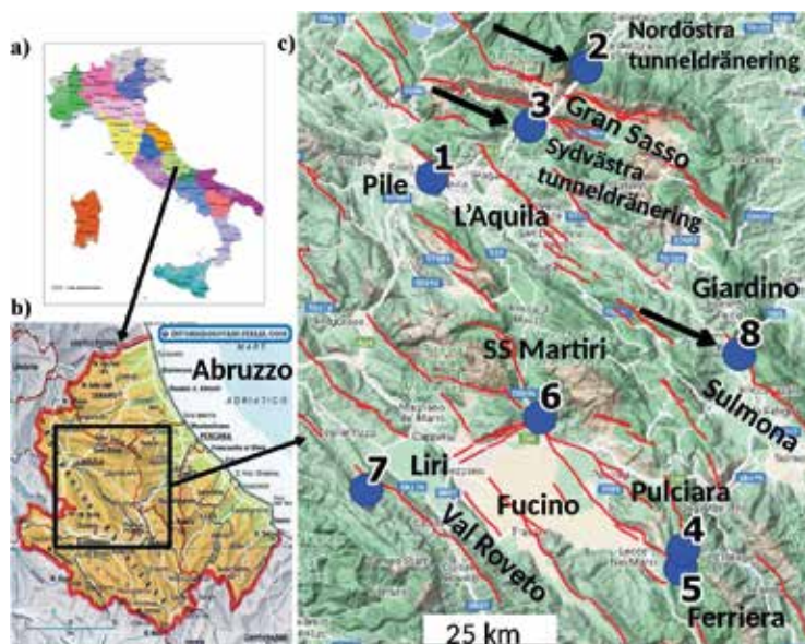
Figur 9: Abruzzoregionen i Italien, där de blå punkterna indikerar några lämpliga platser för sensorinstallation. Sensorenheter placerades ut på plats 2: nordöstra (NE) Gran Sasso tunnelndränring, plats 3: sydvästra (SW) Gran Sasso tunnelndränring, och plats 8: Giardino-källan. Övriga siffror markerar de platser som kommer att användas vid framtida installationer. De röda linjerna markerar förkastningar. Området drabbas av återkommande jordbävningar.
