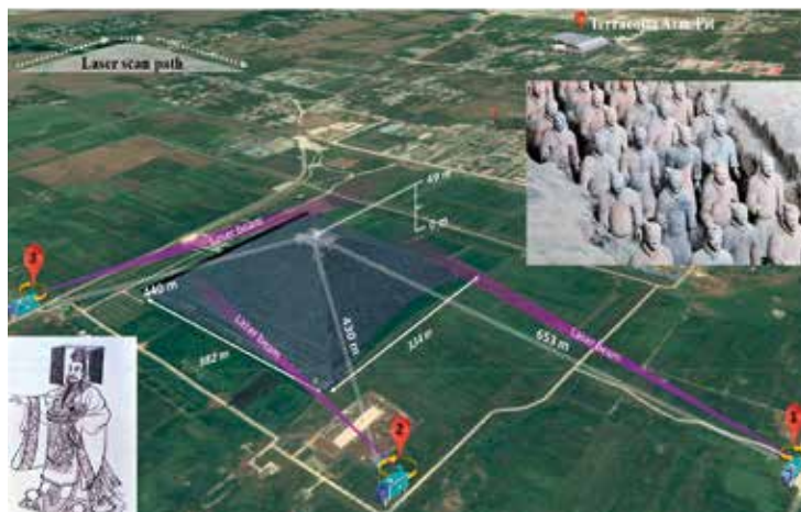
Figur 4: Kejsaren Qin Shi Huangdis mausoleum i Xi'an, som vaktas av den berömda terrakottaarmén, befanns i lidarmätningar vara inbäddad i en svag halo av förgasat kvicksilver, som torde komma från den djupt liggande gravkammaren. (Zhao, G., Zhang, W., Duan, Z. et al. Mercury as a Geophysical Tracer Gas – Emissions from the Emperor Qin Tomb in Xi'an Studied by Laser Radar. Sci Rep 10 , 10414 (2020). https://doi.org/10.1038/s41598-020-67305-x ).
