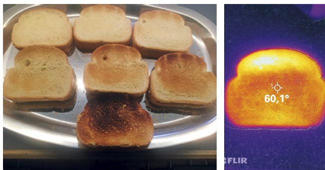
FIGUR 4 Till vänster 14 skivor rostade i par i rostens sju steg och visas vända så att de legat lika i rostningen. Till höger syns att temperaturen är hög. Emellertid är brödets värmeledning dålig och dess (specifika) värmekapacitet liten. Man kan därför bita i det nyrostade brödet, precis som man kan gå på glödande kol.
